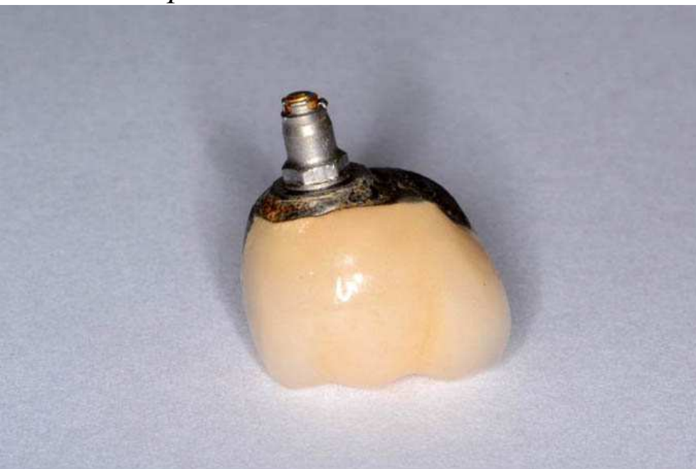
Фото 3. Перелом гвинта абатмента
