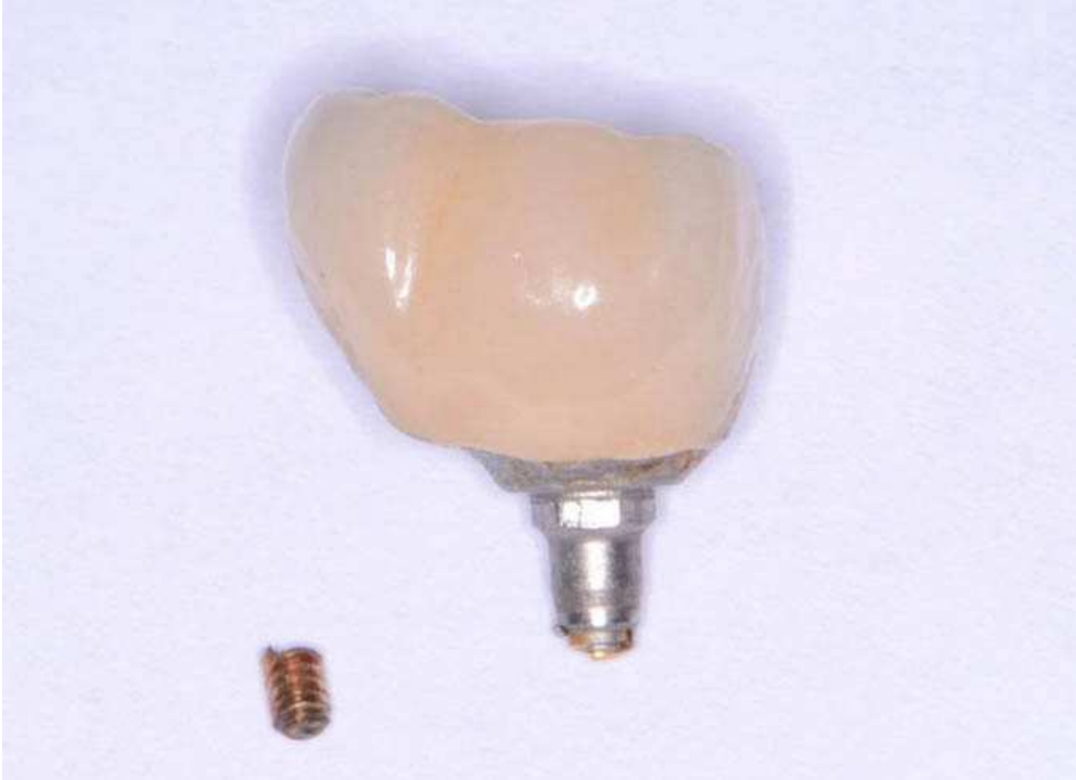
Фото 3. Перелом гвинта абатмента
