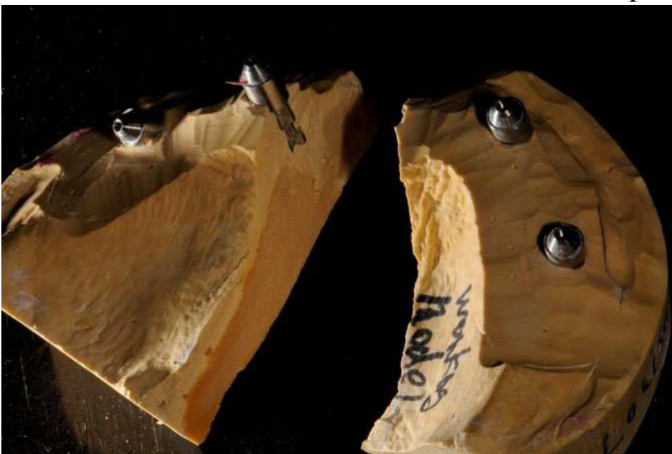
Фото 10. Вигляд перелому моделі без підтримки металевих балок
