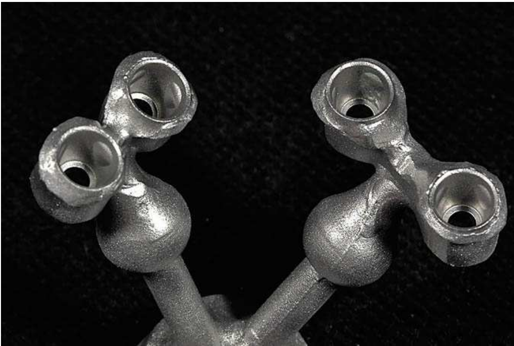
Мал. 14. Заміна воску на метал (кобальто-хромовий сплав)
