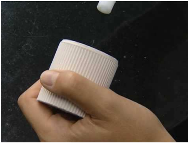
Отримана прес-форма Розміщення отриманої форми в муфельній печі для вигорання воскової репродукції:
