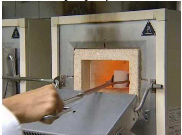
Отримана прес-форма Розміщення отриманої форми в муфельній печі для вигорання воскової репродукції:
