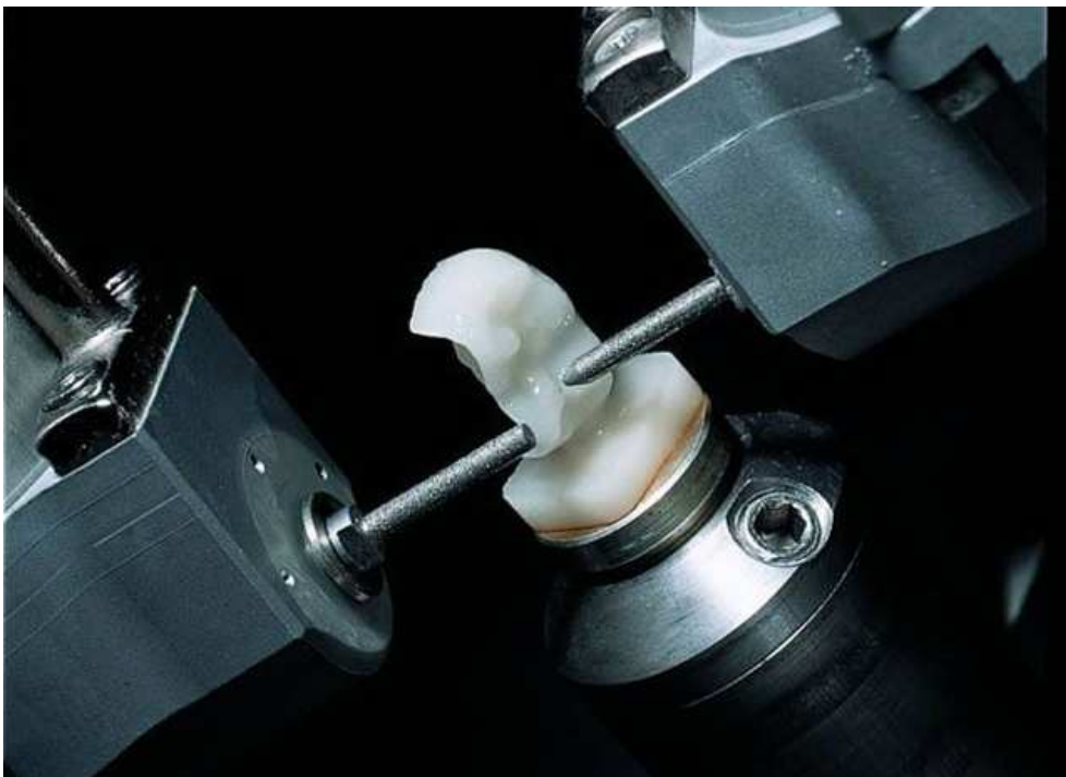
Фрезерування оксид-цирконієвої вкладки
