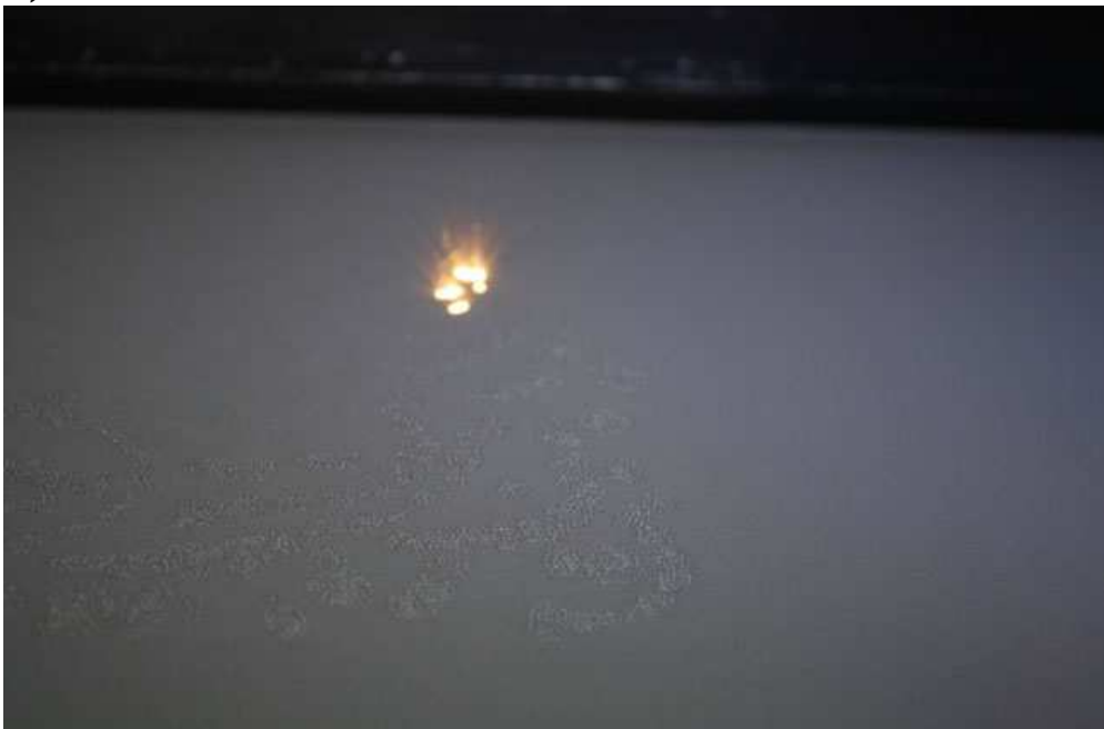
Мал. 3. Спікання спрямова- ним лазером
