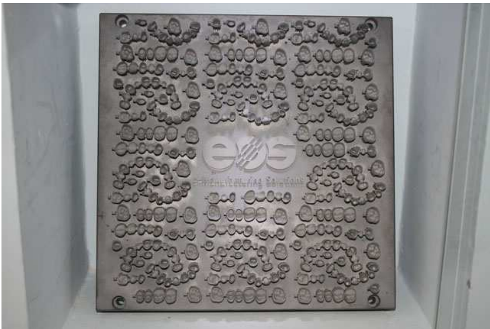
Мал. 8. Металева основа з роз- ташовани- ми на ній металевими рестав- раціями
