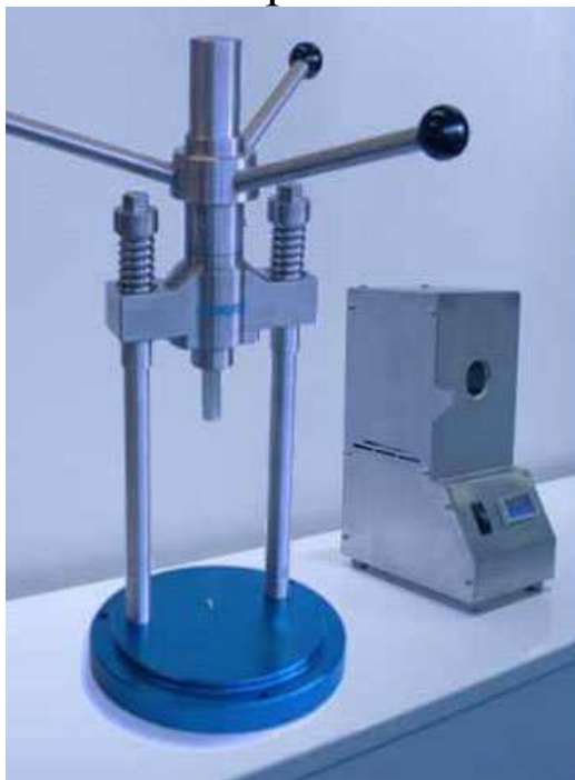
Ручний прес фірми Valplast (США) для інжекції термопластичних протезів (поруч із пресом муфель (піч) для розігрівання кювет з картриджами)
