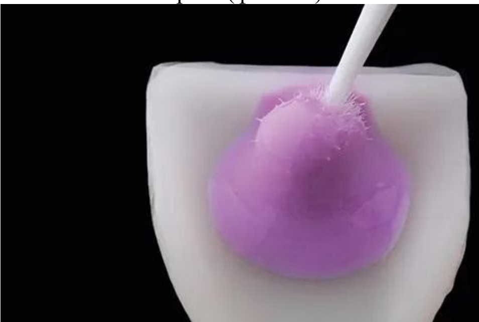
Фото 12: Нанесення очисника на внутрішню поверхню, промивання і висушування
