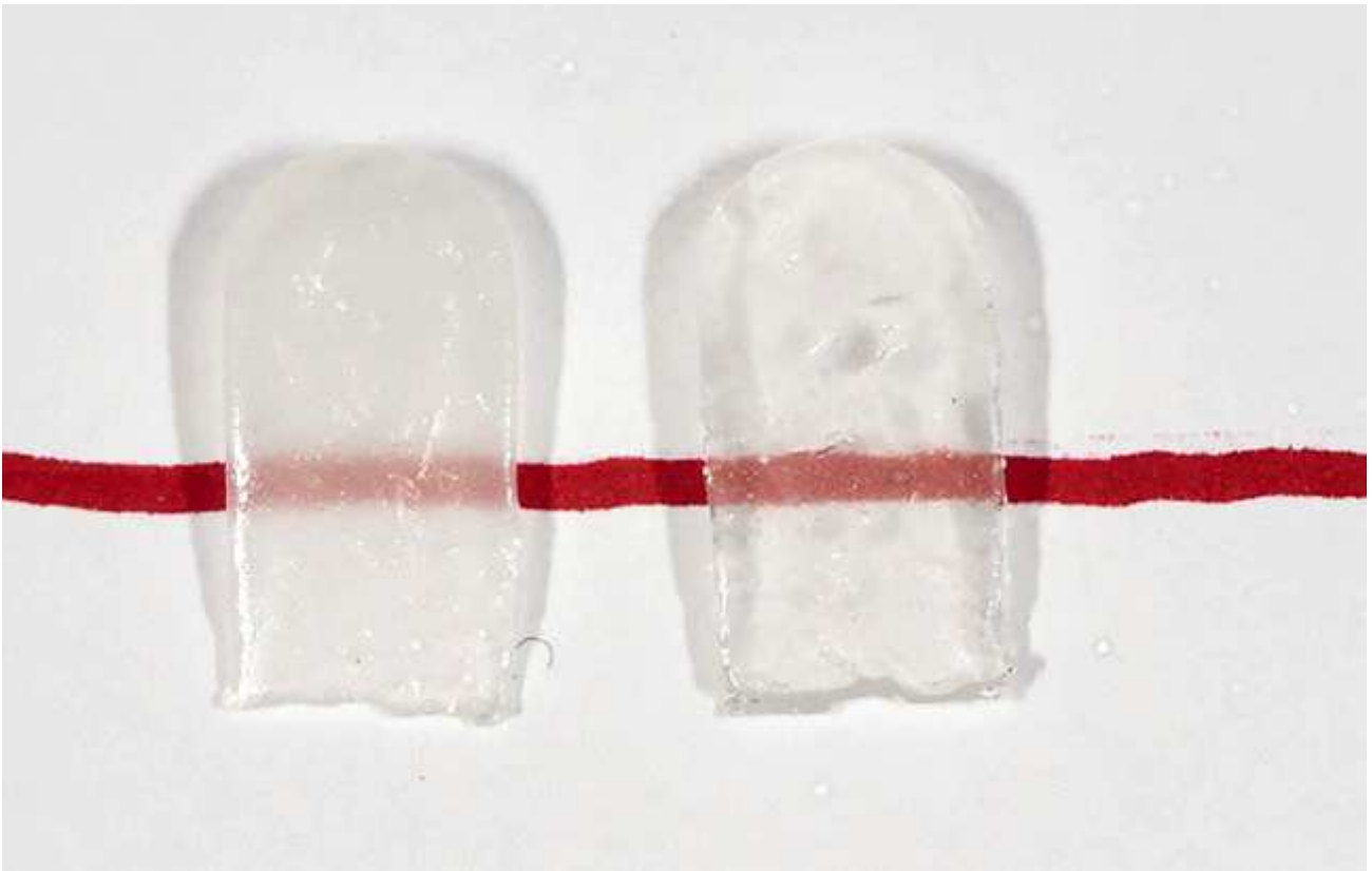
Мал. 10. Різниця в прозорості між масою CL-O (ліворуч) і UC (праворуч) системи Creation CC
