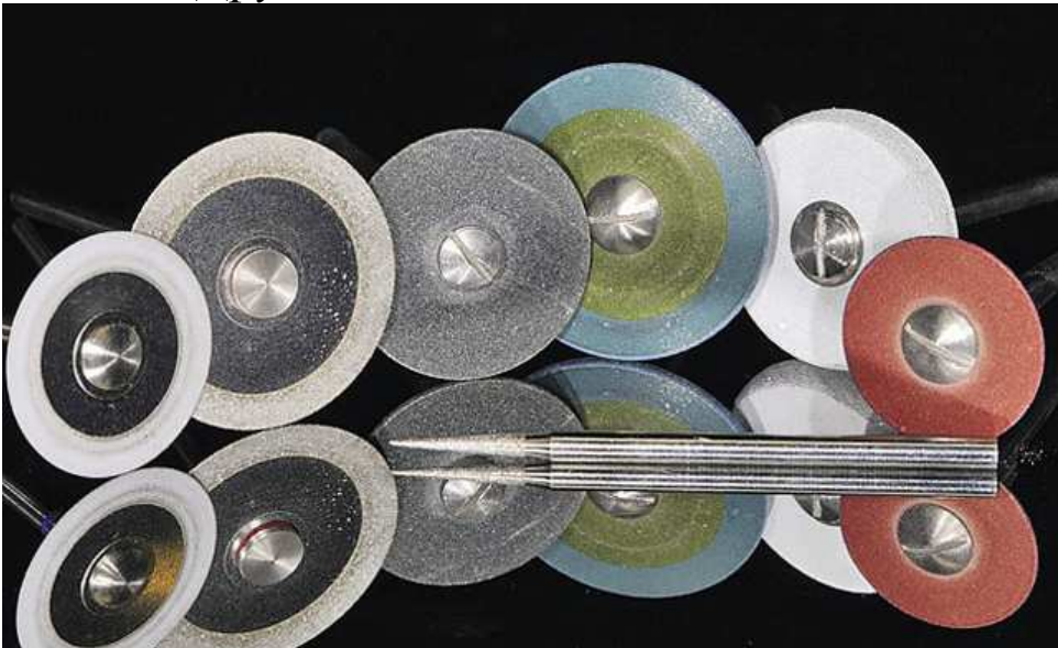
Мал. 16. Фрези, гумки, алмазні диски для обробки
