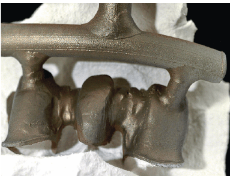
Мал. 5. Об'єкт з благородного сплаву на відцентровій установці
