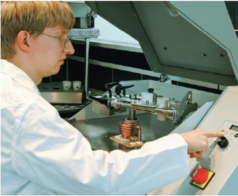
Мал. 3. Процес литва на відцентровій індукційній ливарній установці
