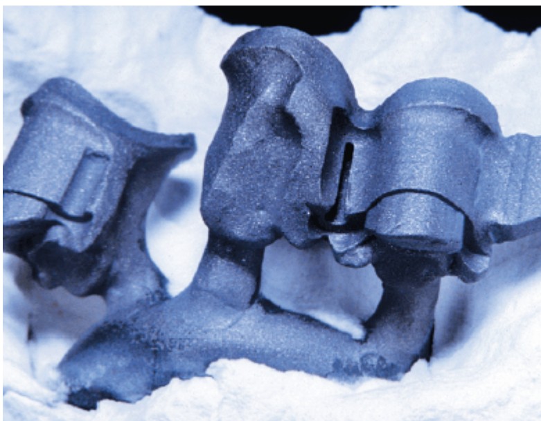
Мал. 7. Об'єкт з небагородного сплаву на вакуумній установці під тиском
