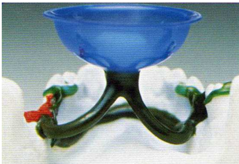
Під'язична дуга: 2 ливника 3,0 чи 3,5 мм.
