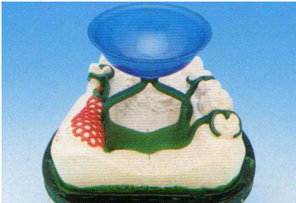
Високочастотне вакуумне литво під тиском: 2 плоских ливника 2,0x4,5 мм.
