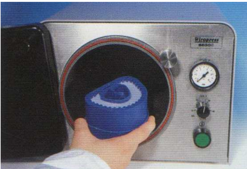
Силікон твердне в приладі під тиском 4 бара
