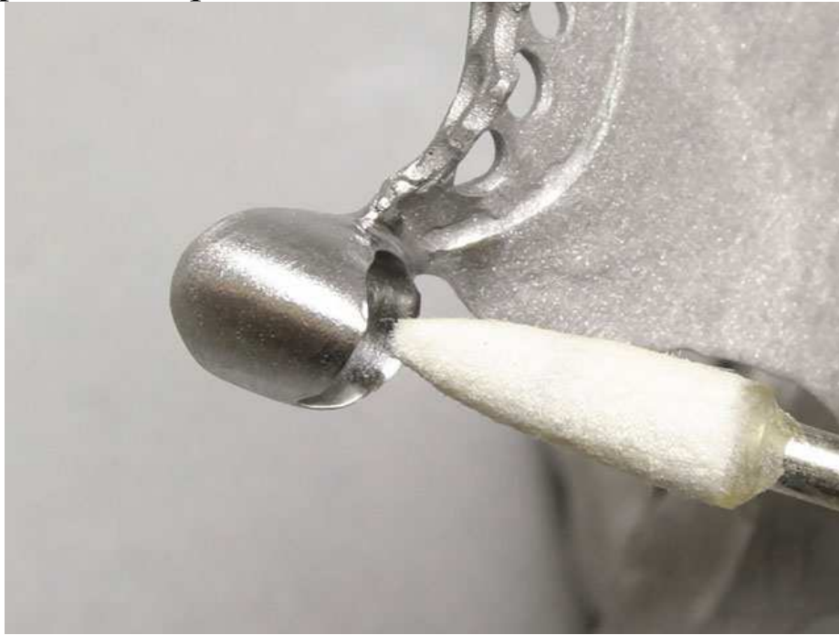
Мал. 25. Полірування за допомогою повстяних конусів і алмазної полірувальної пасту ТЕК-1 POL
