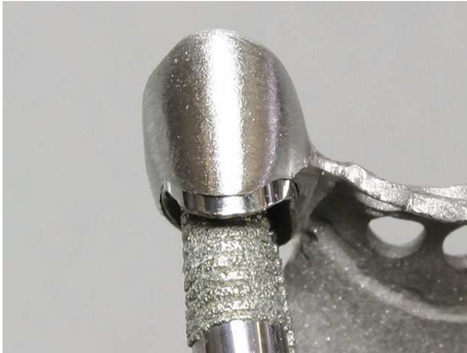
Мал. 23. Після усунення дефектів литва телескопи мають бути припасовані ідеально на 90-95 %
