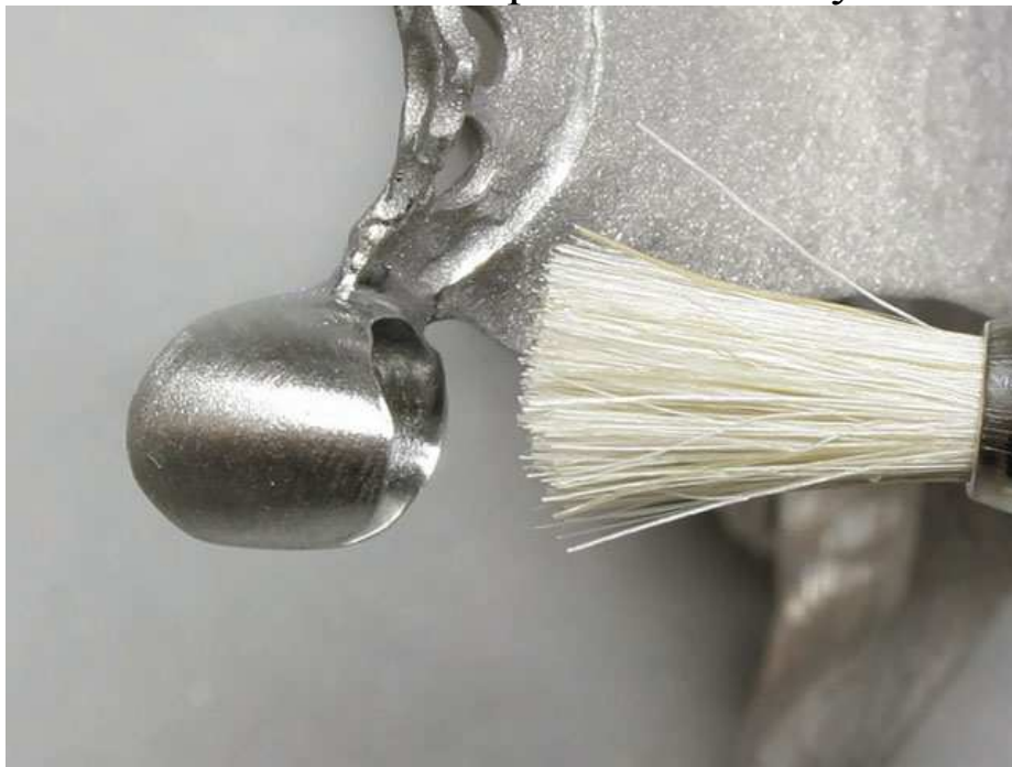
Мал. 26. Ідеальна дзеркальна поверхня може бути отримана за допомогою жорсткої, а потім м'якої щітки
