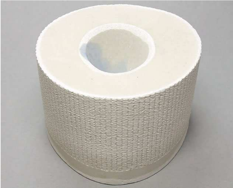
Мал. 21. Велика площа поверхні швидше нагрівається і швидше остигає після відливання
