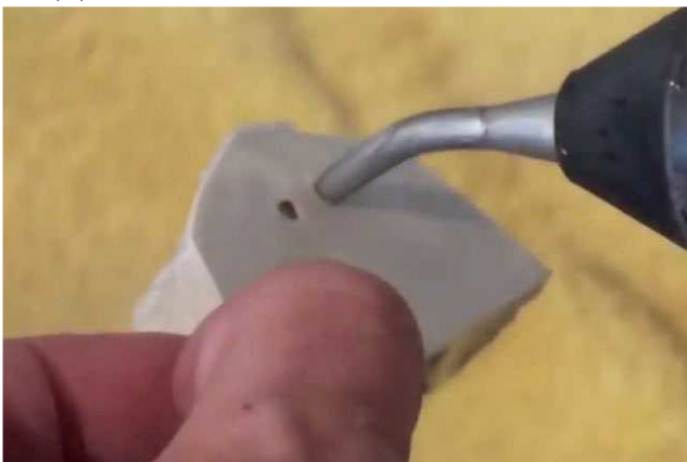
14. Витравлення пароструменем віддубльованих штампіків з моделі:
