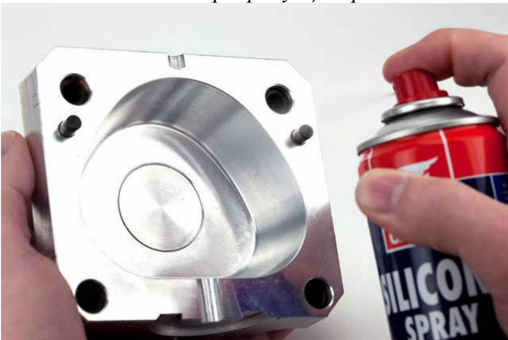
Ізоляція кювети силіконом для полегшення демонтажу гіпсової прес-форми з термоінжекційної кювети
