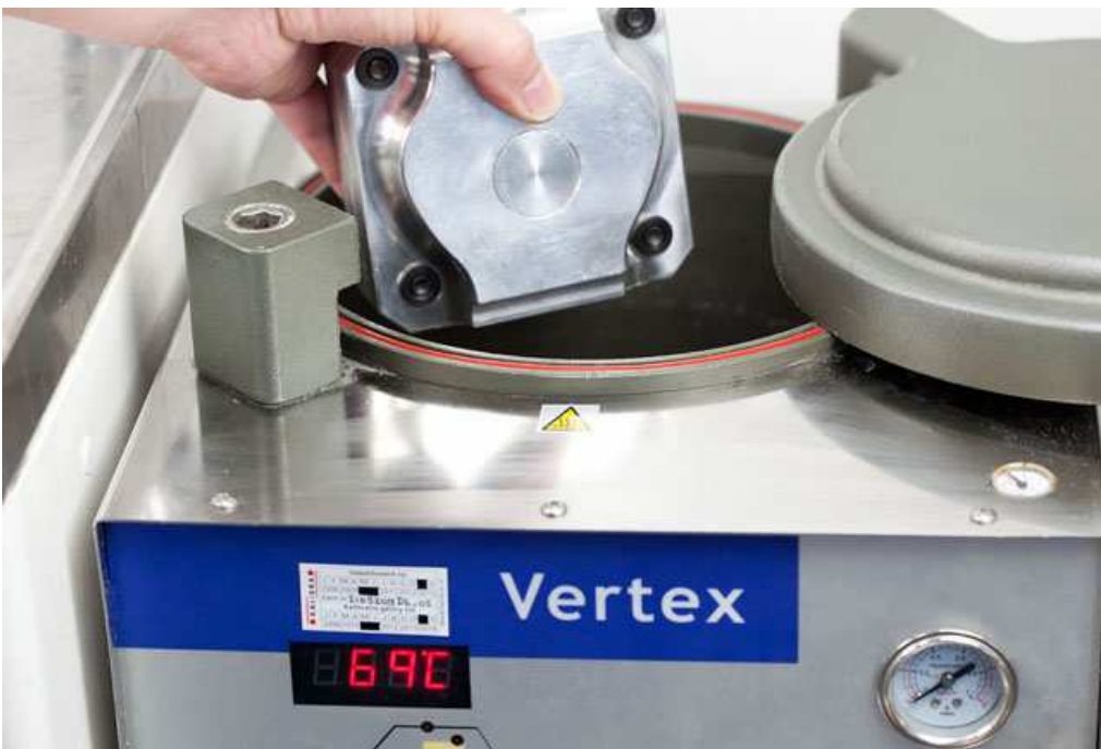
Виплавлення воску термопарою
