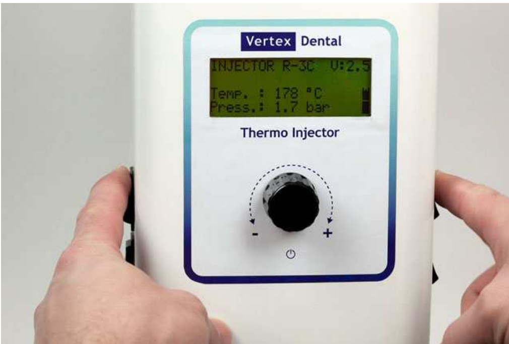
Програмування термопресу для інжекції до вибраного термопластичного матеріалу
