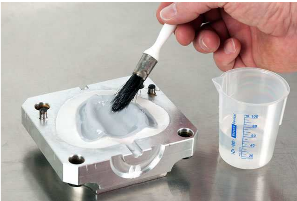
Нанесення розділюва- льного лаку Easyflow, Divosep та ін.
