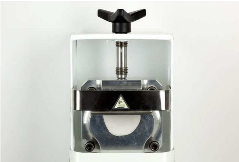
Монтаж кювети в термопрес
