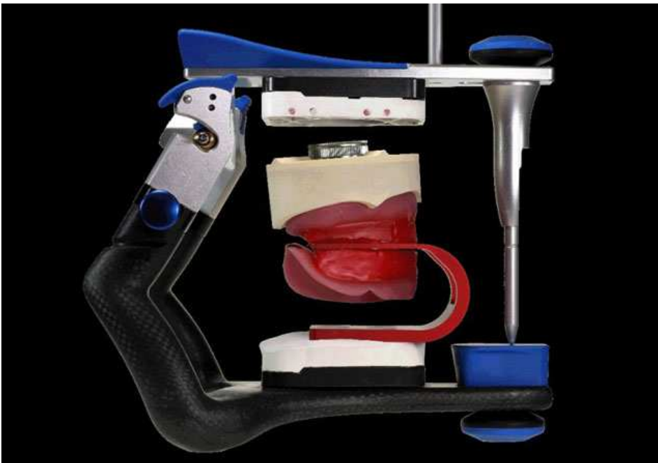
Мал. 12 Загіпсовка мо- делей починає- ться з верх- ньої моделі. У встановлений пристрій з ок- люзійними ва- ликами кладе- ться верхня модель і загіп- совується
