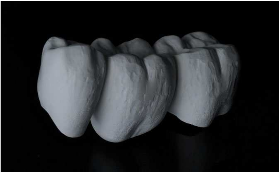
Фото 7: Текстурування поверхні в заздалегідь спеченому стані (перед остаточною процедурою спікання)
