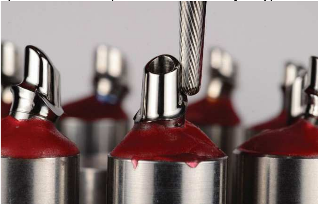
Фото 3. Показаний процес ручного фрезерування основного абатмента
